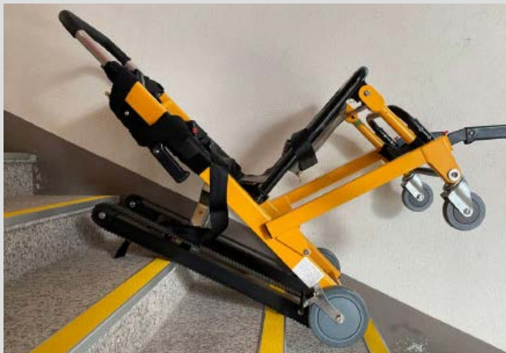
[그림 22] 휠체어 사용자를 위한 계단 이송용 보조도구 (대학로예술극장 대극장 3층 비치)
